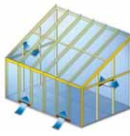
Die Abluft wird über die Walzenlüfter und Oberlichter nach außen geleitet. Zuluft gelangt über Türen, Schiebelüfter, Schiebetüren und Fenster hinein.
