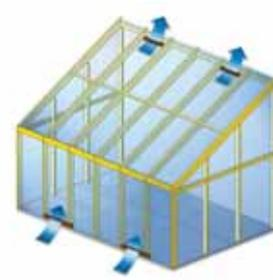
Entlüftet wird über Dachlüftungsklappe oder Walzenlüfter. Zuluft erfolgt über Fenster, Klappen und/oder Schiebelüfter, die unten angebracht sind.
